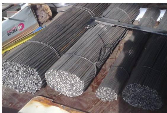
Слика 1. Изглед шипки пречник 3,25 мм и дужине 350мм добијене после равнања и сечења пуњене (а) и пуне жице (б)
