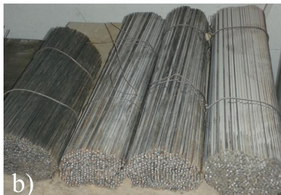
Слика 1. Изглед шипки пречник 3,25 мм и дужине 350мм добијене после равнања и сечења пуњене (а) и пуне жице (б)
