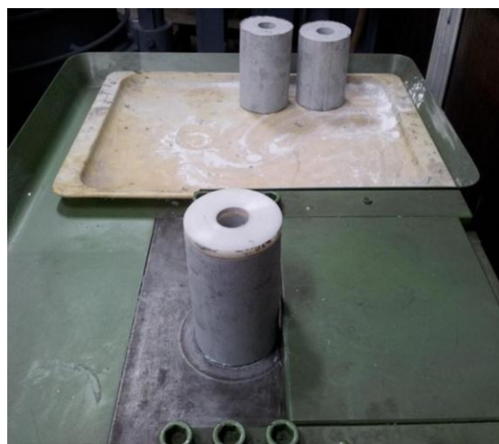
Слика 2. Мешање компоненти са везивом (а) и израда брикета(б) за облагање електроде
